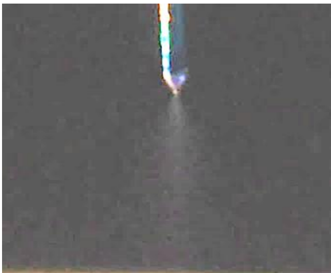
Рисунок 3.1- Фотография конуса Тейлора на конце капилляра со стационарным дисперсным потоком чернил струйного принтера марки "chameleon" при 500 кратном увеличении. Наружный диаметр капилляра составляет 0,38 мм.
